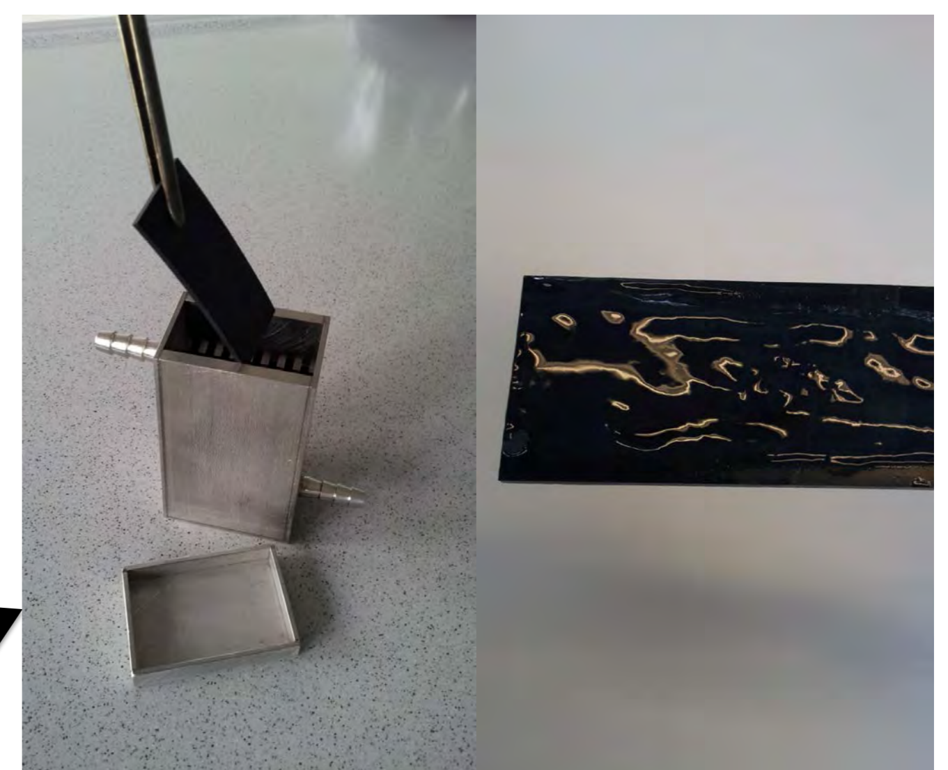
Biofilmreaktor Trinkwasserbiofilm auf EPDM-Coupon
